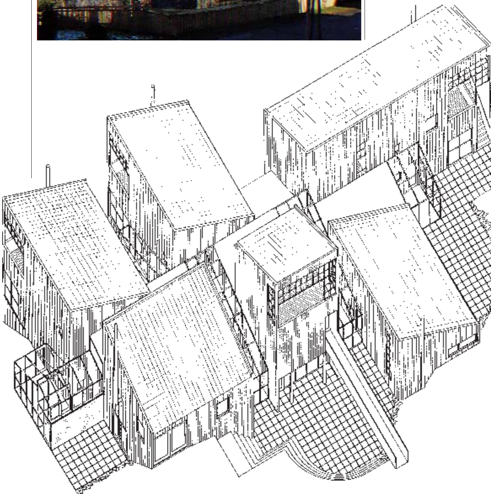
Bofellesskapet består av en gruppe småhus omkring den felles glassgata.
